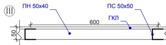
Облицовка существующих разделительных перегородок из ГКЛ одним слоем гипсокартонных листов толщ. 12,5мм на металлическом каркасе, С625 - по системе КНАУФ(без утеплителя), на высоту 3300 мм.
