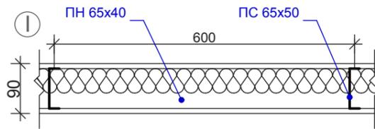
Перегорodka C111 - по системе КНАУФ, (E145-предел огнестойкости, 45 мин) толщ. 90 мм из ГКЛ по металлическому каркасу с заполнением пустот негорючей мин. плитой IZOVOL Ст50 толщиной 50 мм и плотностью 40 кг/м<sup>3</sup>. Обшивка в один слой ГКЛ толщ. 12,5 мм с обеих сторон. Обшивку выполнить на высоту 3300 мм от чистого пола.
